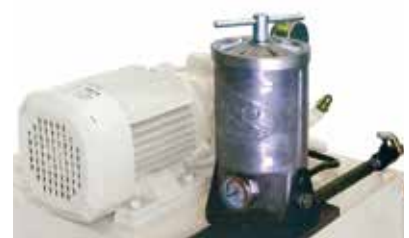
油圧オイル濾過装置
